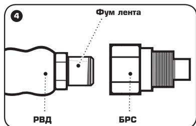
4. Установите быстроразъемное соединение БРС на место, предварительно уплотнив резьбовое соединение фум-лентой.
